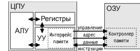
Рисунок 3: Логическая структура ЦПУ и взаимодействие ЦПУ с ОЗУ
