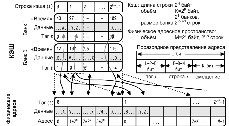
Рисунок 26: Пример отображения строк множественно-ассоциативного кэша в строки оперативной памяти.
